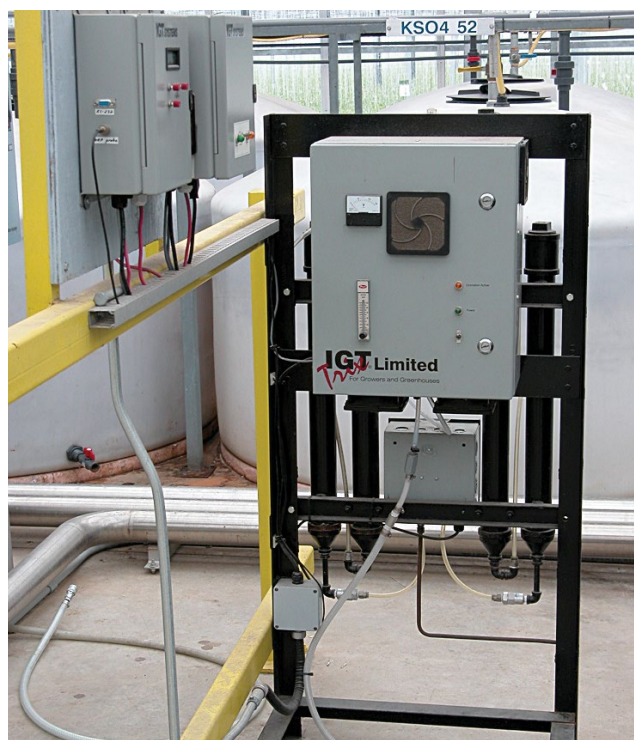
Figure 21. Système de désinfection à l'ozone.
