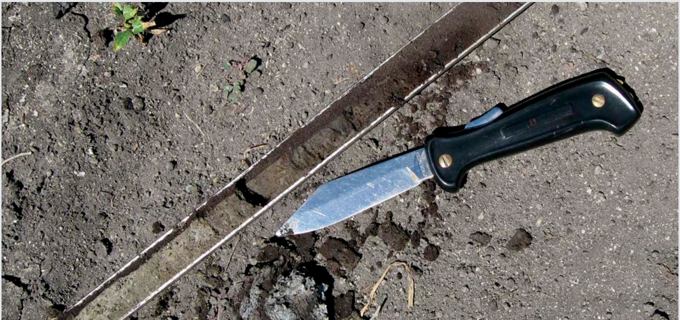
Une sonde tubulaire peut rapidement donner la profondeur de la couche de terre noire organique et le degré de mélange avec la couche minérale inférieure. Cette sonde mesure 30 cm.
