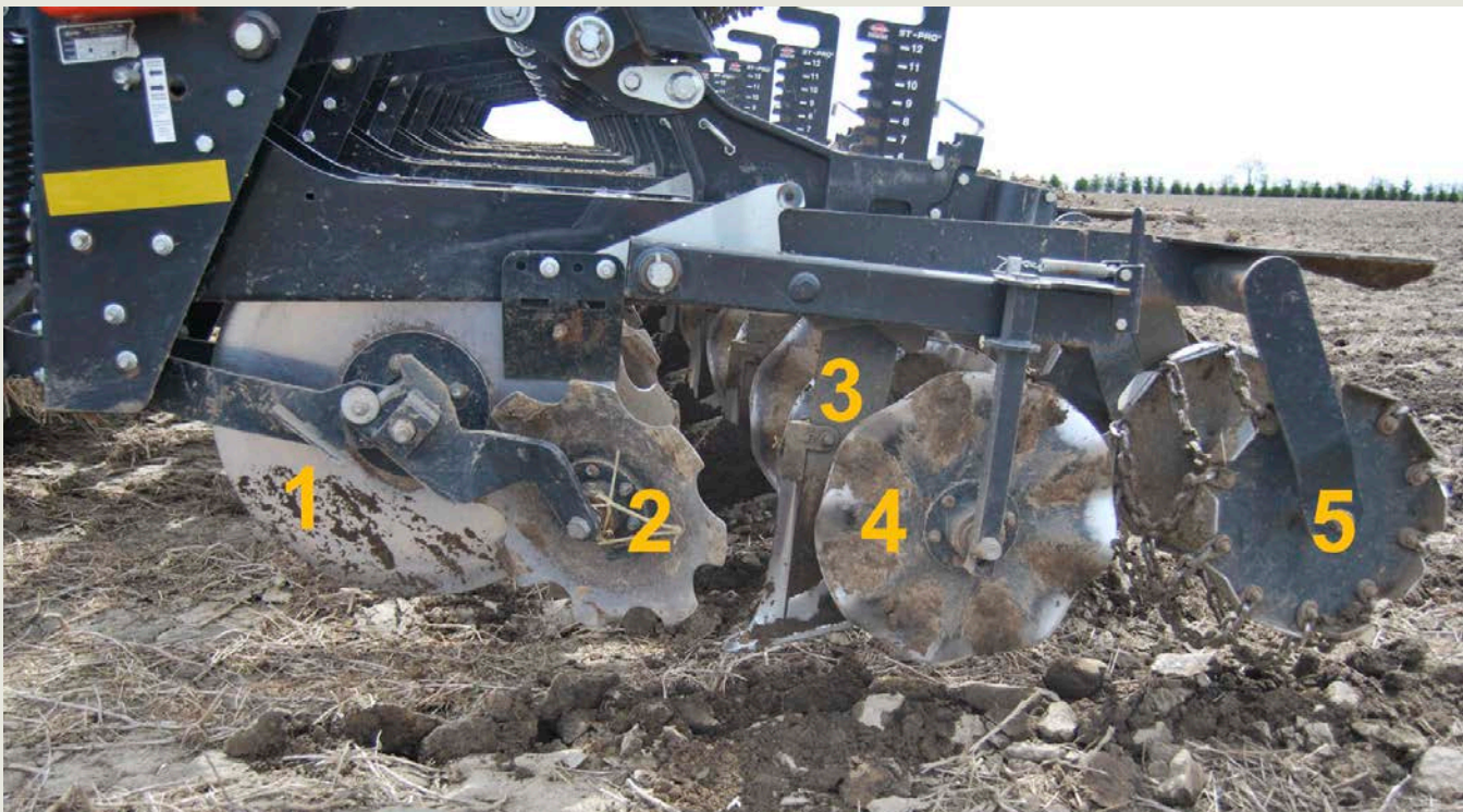
Figure 3. Exemple de la configuration d'une unité de travail du sol. De gauche à droite, chaque unité comprend : (1) coutre tranchant, (2) tasse-résidus, (3) dent, (4) coutre de travail/confinement, (5) rouleau cage.
