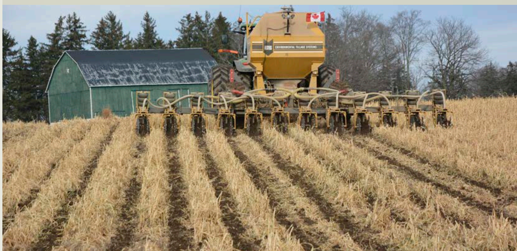
Figure 1. Le travail du sol en bandes permet de combiner le labour primaire avec l'épandage d'engrais et le labour secondaire (dans le cadre d'un même passage), ce qui accroît l'efficacité du système cultural.
