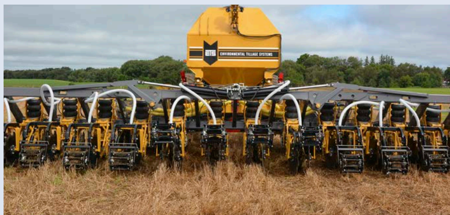
Figure 9. Certaines machines de travail du sol en bandes, comme cette unité avec des coutres, sont équipées avec des systèmes d'épandage d'engrais sec.
