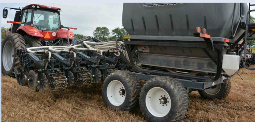
Figure 10. Des épandeurs pneumatiques peuvent également être ajoutés à l'équipement de travail du sol en bandes, tel qu'illustré ici.
