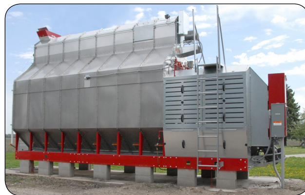
Figure 1. Séchoir à grain classique. Il s'agit ici d'un modèle horizontal à écoulement transversal continu sans récupération de la chaleur. Source : Brock Grain Systems, Milford, Indiana, États-Unis.
